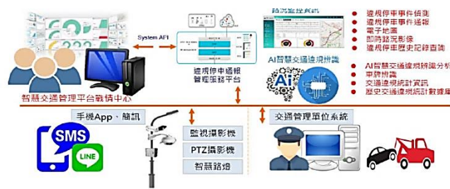
圖一、車輛紅線違停偵測應用服務解決方案架構
