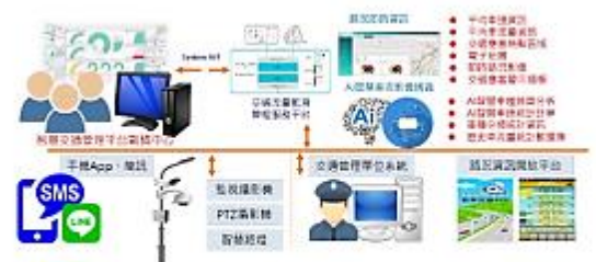
圖二、交通流量監測分析應用服務解決方案架構
